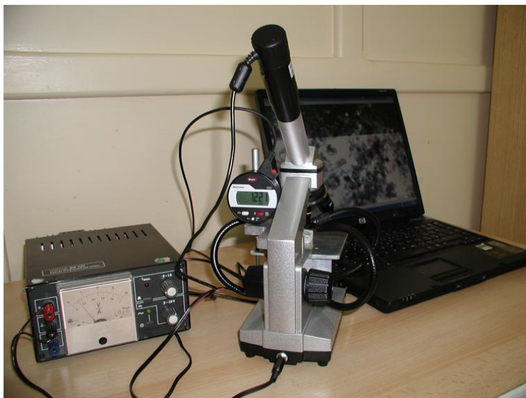
Obr. 3 Pohled na napájecí zdroj LED diod, USB kameru a digitální úchylkoměr s notebookem
