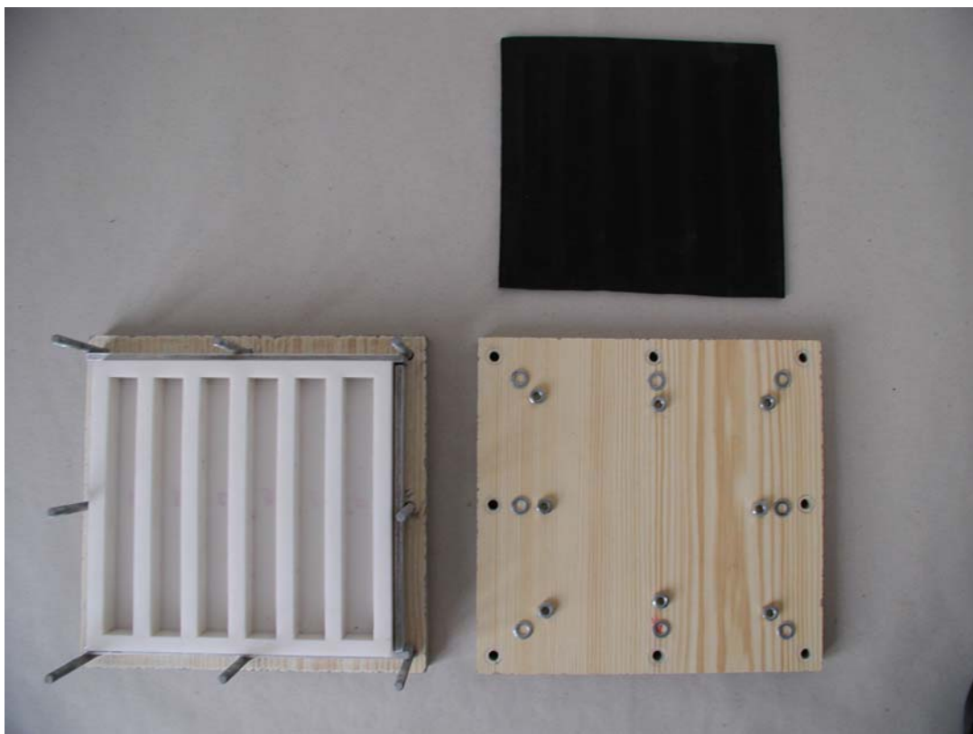
Obr. 4 Sendvičová sestava pro vodotěsné zakrytování polymerních forem.
