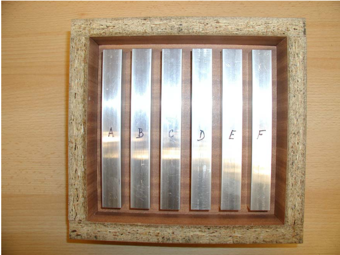
Obr. 2 Přípravek pro výrobu polymerních forem
