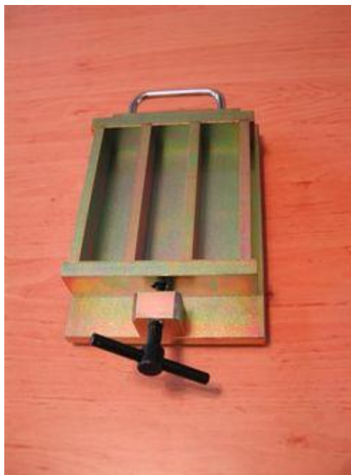
Obr. 1 Běžně používaná kovová rozebíratelná forma pro cementové vzorky
